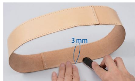
6 離底部皮革的底部面3mm的地方，用搓刀條進行磨砂加工。
