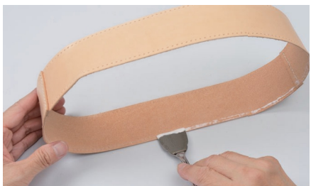
10 底帶皮革經過磨砂處理的部分，也用抹刀塗上皮革黏合劑。
