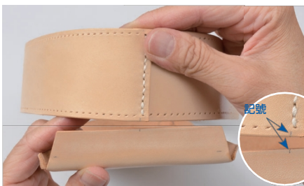
7 將底部皮革短邊中間的記號與底帶皮革外側的記號對齊，然後將底部皮革放進去內側。
