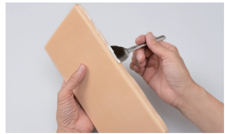
9 用抹刀將皮革黏合劑塗在底部皮革經過磨砂處理的地方。
