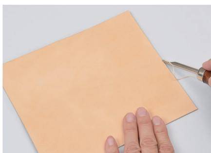
**4** 使用輪廓刀先修削開口處的邊緣角，依次從亮面開始，然後是底部面。請注意要握緊輪廓刀，並小心逐漸地將輪廓刀片向前滑動。
